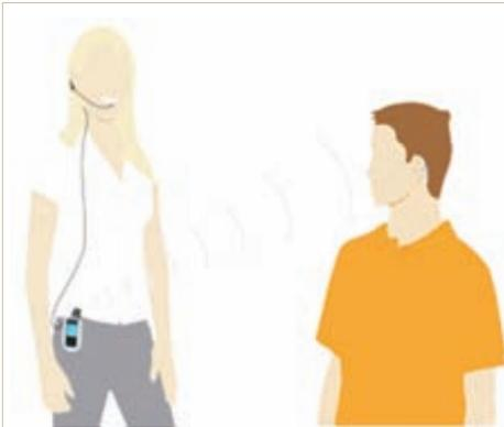
**FIGURA 8** – O som é captado por um microfone e enviado por meio de frequência modulada para o receptor que deverá estar conectado ao aparelho (figura 8) ou fone (figura 9).
